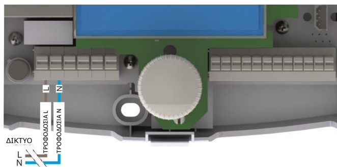
Εικ. 16-5 Σύνδεση τροφοδοσίας δικτύου
